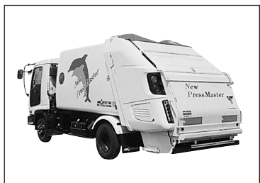
計量装置付圧縮式塵芥収集車 （プレスマスター）
